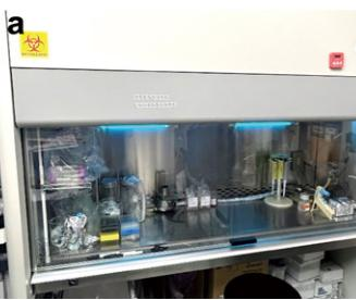
図a 生物学的安全性試験のための classII 安全キャビネット
