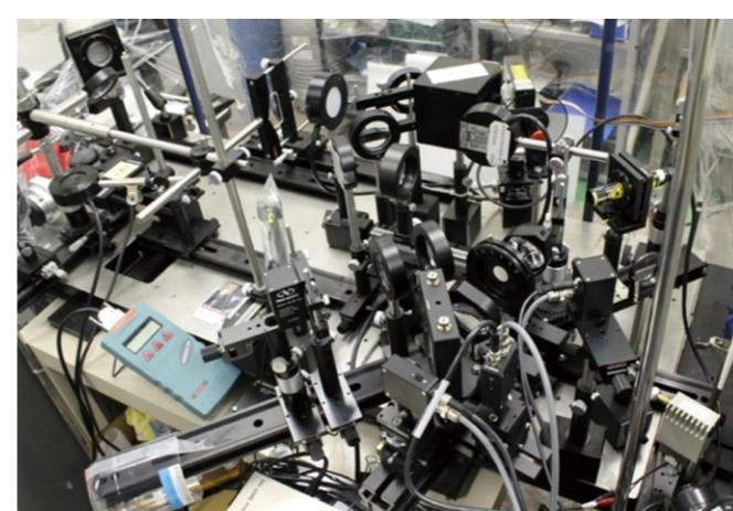
図1 ナノ秒温度計測システム全景
