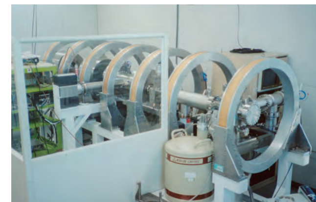
■私達が開発したエネルギー可変低速陽電子ビーム材料評価装置 任意のエネルギーに単色化した低速の陽電子ビームを試料中に入射させ、陽電子が試料内の電子と対消滅して放出する \gamma 線のエネルギー分析を行って、表面・界面近傍のナノ構造欠陥の深さ分布を測定する装置。
