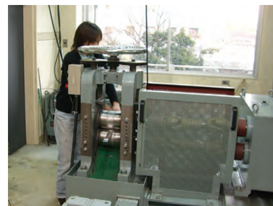
■非対称圧延による高加工性アルミニウム合金板の創製
