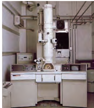
■透過型電子顕微鏡を用いた転位運動のその場観察
